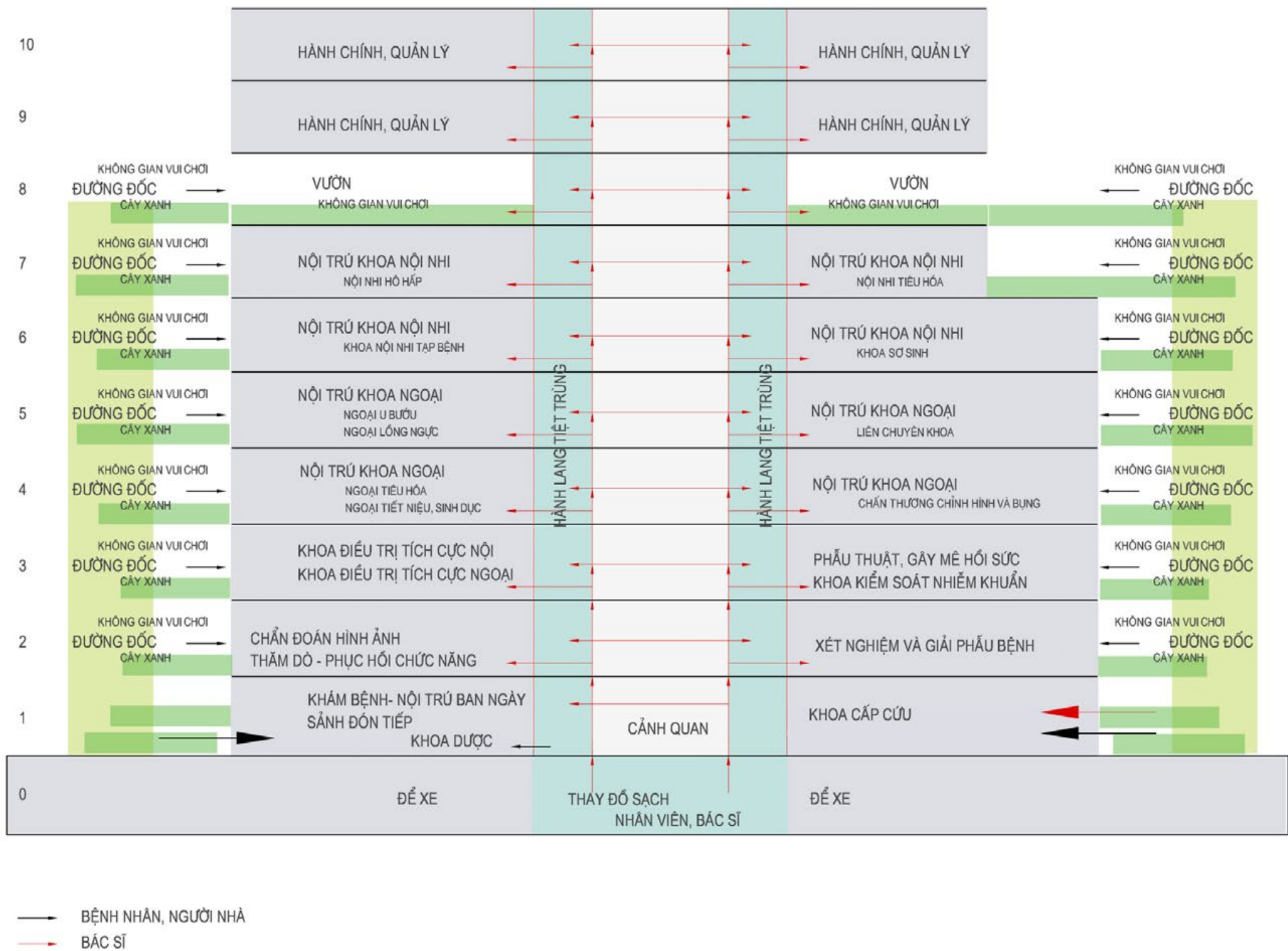
MẶT CẮT LIÊN HỆ CÔNG NĂNG
